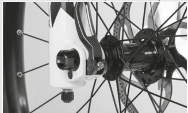
Afbeelding 41: Spankracht van de snelspanner afstellen
