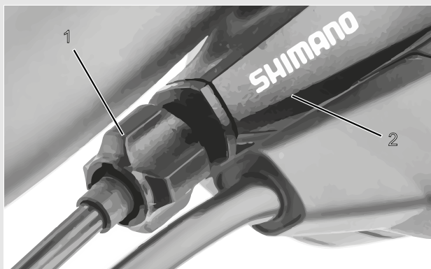
Afbeelding 43: Afstelwartel (1) van de versnelling met enkele bowdenkabelbediening en behuizing van de schakelhendel (2), voorbeeld
