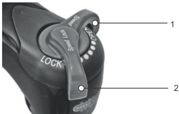
Afbeelding 38: Suntour drukdemperafsteller met de standen OPEN (1) en LOCK (2)
