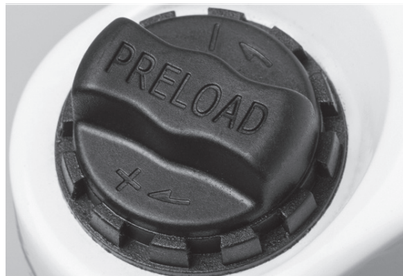
Abbildung 54: Einstellrad des Negativfederwegs auf der Krone der Federgabel
