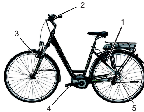
Abbildung 8: Bremssystem eines Pedelecs mit einer Rücktrittbremse, Beispiel
