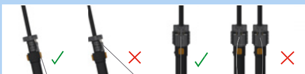
Illustration 188 : Câble Bowden correct et incorrect
