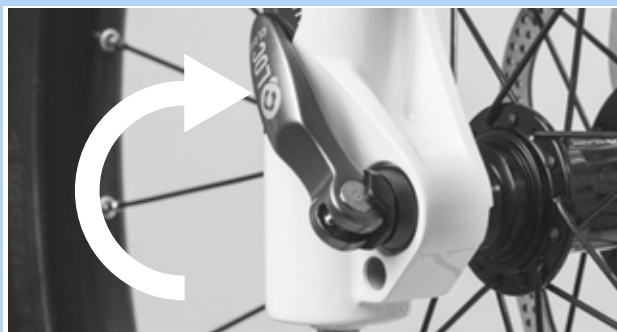
Illustration 79 : Fermer l'attache rapide
