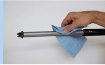
Illustration 214 : Nettoyer la rainure de guidage longitudinale
