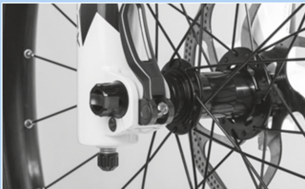
Illustration 74 : Position parfaite du levier de serrage
