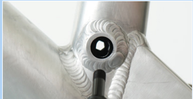
Illustration 221 : Trou de l'interface Postpin
