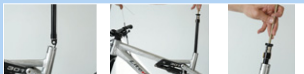
Illustration 189 : Fixer le couvercle de valve de la cartouche
