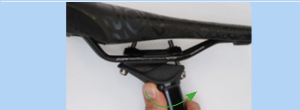
Illustration 212 : Ouvrir le réglage de la hauteur
