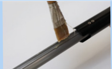
Illustration 215 : Appliquer de la graisse
