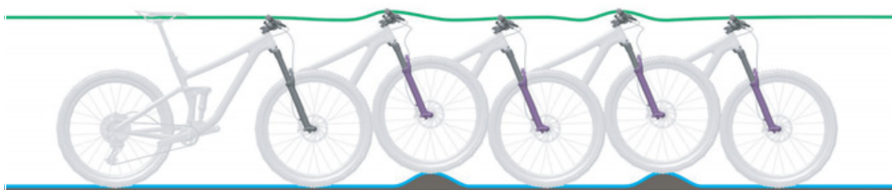
Illustration 112 : Comportement optimal de la fourche
