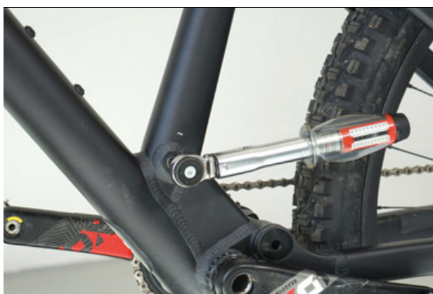
Illustration 87 : Serrer l'axe de la tige de selle
