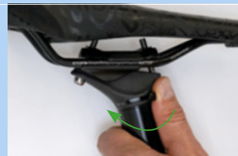
Illustration 217 : Fermer le réglage de la hauteur
