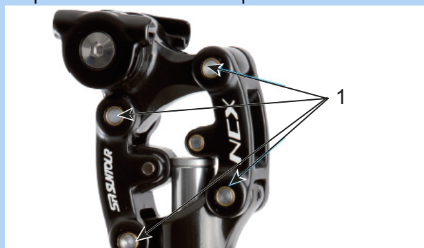
Illustration 160 : Points de lubrification de la tige de selle suspendue SR Suntour
