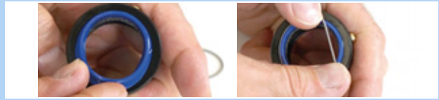
Illustration 210 : Insérer et fixer le joint anti-poussière
