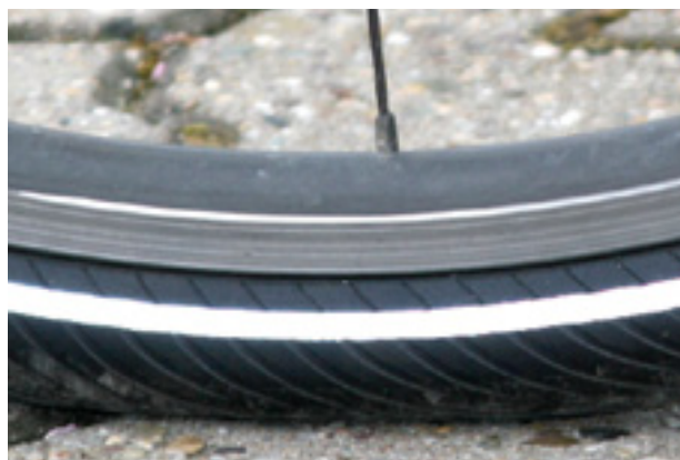
Illustration 103 : Pression correcte. Le pneu se déforme à peine sous le poids du corps
