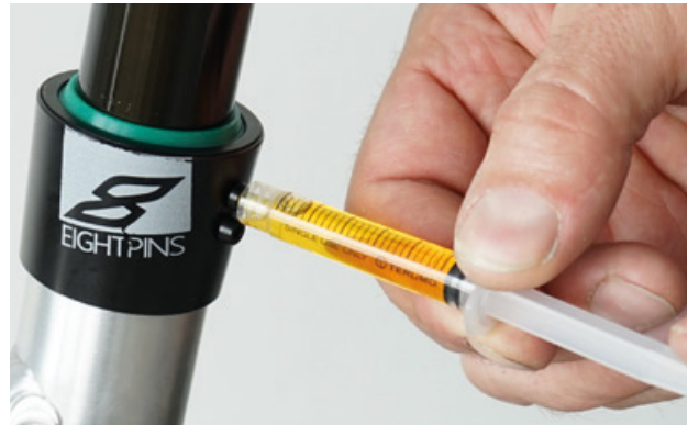
Illustration 146 : Lubrifier un tube de tige de selle
