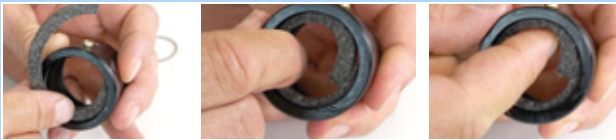
Illustration 147 : Insérer l'anneau de feutre
