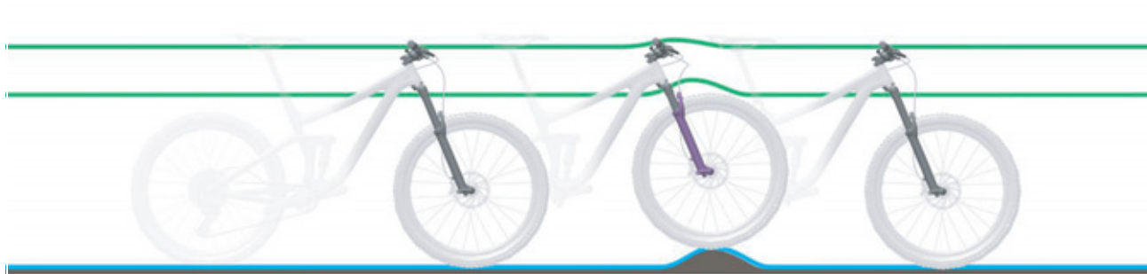
Illustration 112 : Comportement optimal sur les irrégularités
