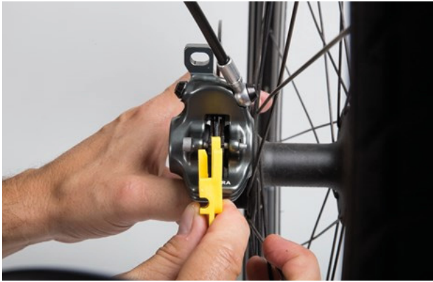
Illustration 123 : Contrôler la plaquette de frein montée à l'aide de la cale de transport
