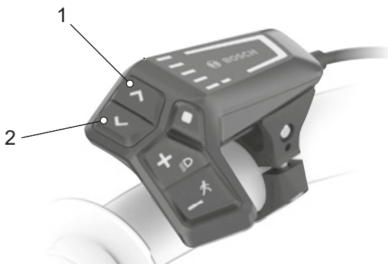
Illustration 106 : Position de la touche d'augmentation de la luminosité (2) et de la touche de réduction de la luminosité (1)
