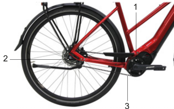
Illustration 26 : Schéma de l'entraînement à courroie
