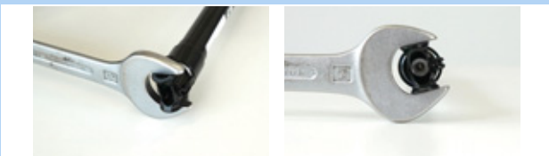
Illustration 155 : Empêcher l'interface de montage de tourner
