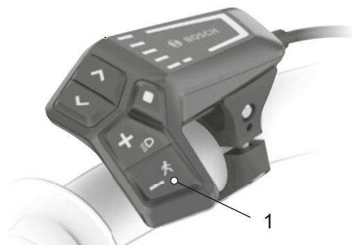
Illustration 107 : Position de la touche d'assistance de poussée (1)
