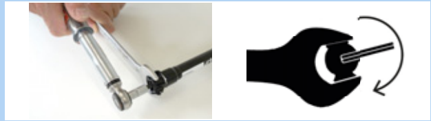
Illustration 156 : Régler dans le sens des aiguilles d'une montre
