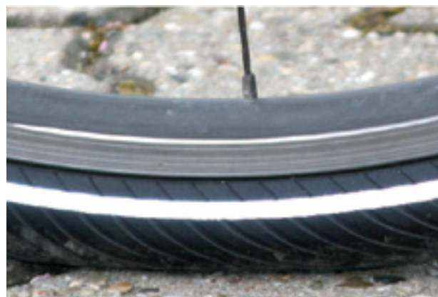
Illustration 78 : Pression correcte. Le pneu se déforme à peine sous le poids du corps
