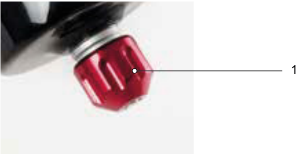
Illustration 197 : Vis de détente Suntour (1)
