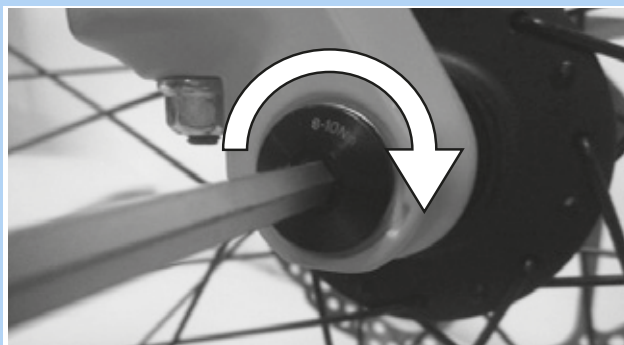
Illustration 44 : Serrer l'axe dans le sens de la flèche
