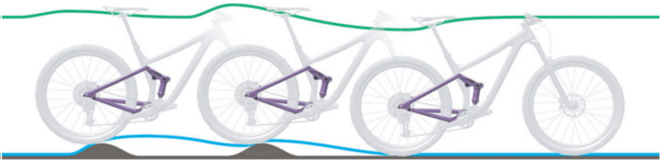
Illustration 214 : Détente trop lente de l'amortisseur arrière
