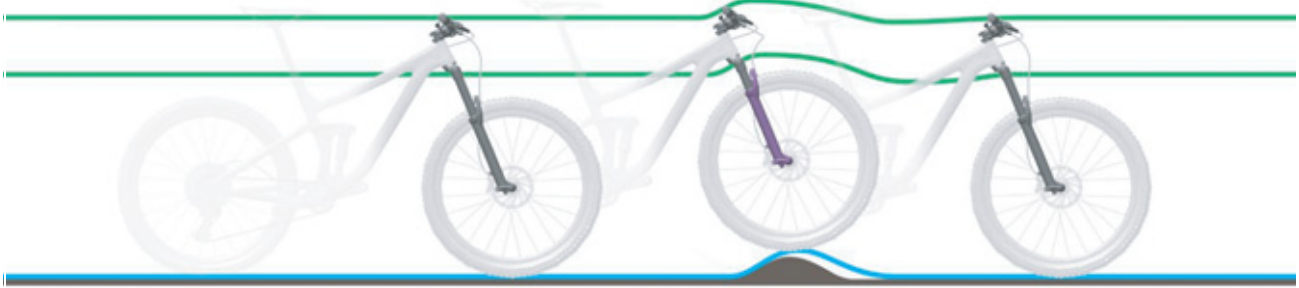
Illustration 202 : Amortissement trop dur de la fourche suspendue en cas d'irrégularités
