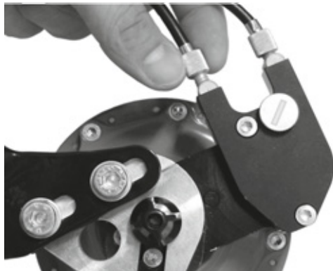
Illustration 127 : Sur les versions de moyeux ROHLOFF avec commande externe du changement de vitesse, le dispositif de réglage de la tension est situé sur le boîtier de câbles qui est placé sur le côté gauche.
