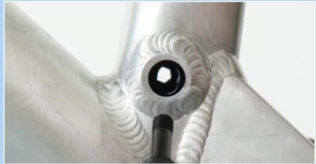
Illustration 194 : Trou de l'interface Postpin
