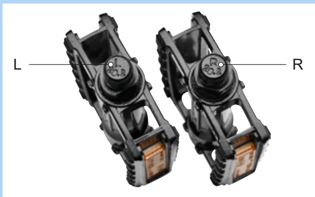
Illustration 57 : Exemple de marquage de pédales
