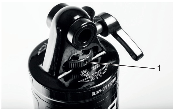
Abbildung 63: Suntour-Zugstufeneinsteller Rad (1) am Hinterbau-Dämpfer
