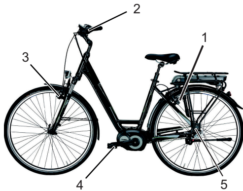
Abbildung 12: Bremssystem mit einer Rücktrittbremse, Beispiel
