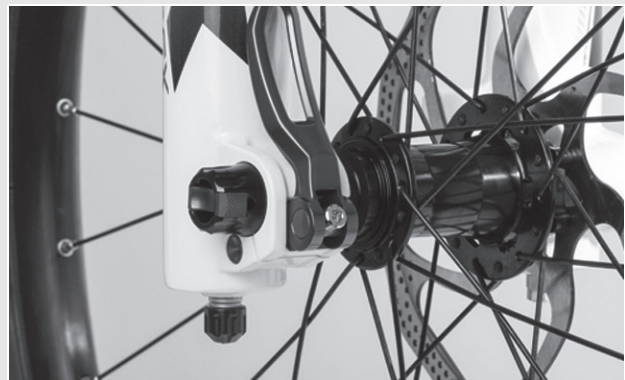
Abbildung 90: Spannkraft des Schnellspanners einstellen
