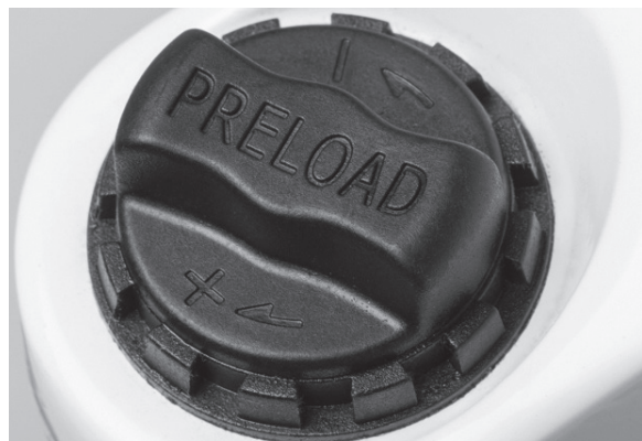
Abbildung 59: Einstellrad des Negativfederwegs auf der Krone der Federgabel
